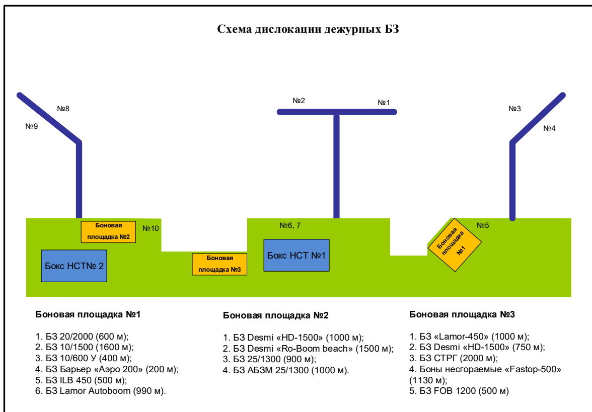
Рисунок 2.3.1 – Схема дислокации дежурных БЗ
