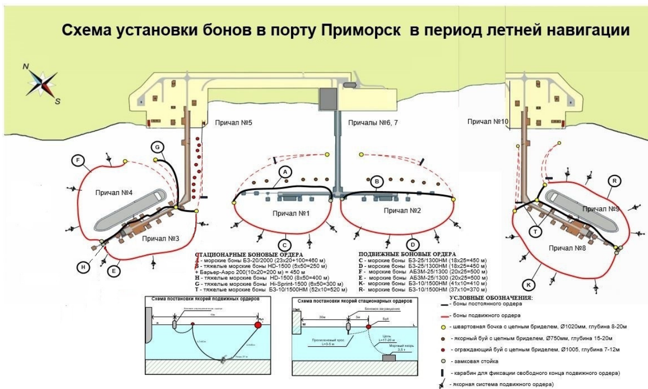
Рисунок 2.3.4 – Схема установки бонов в порту Приморск в период летней навигации
